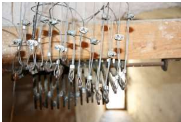
Mécanisme de fonctionnement du carillon
